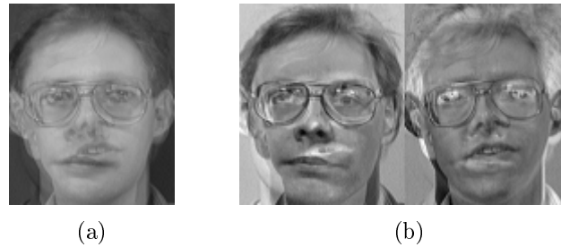
Figura 13 – Imagem média das três faces, obtida após aplicação do PCA (a) e Imagens projetadas no subespaço após aplicação do PCA – eigenfaces (b)
